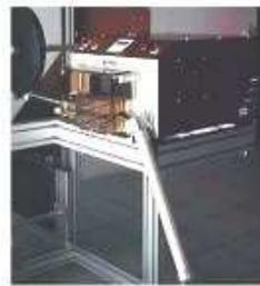
Dérouleur motorisé composé d'un support de bobine, non motorisé, d'un moufflage de stockage, et d'un tracteur motorisé.
