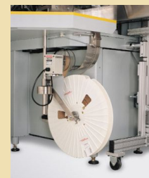
Les portes bobines sont situés sous la plate-forme de la MTX, réduisant ainsi la manutention L'enrouleur de papier gardera le poste de travail net
