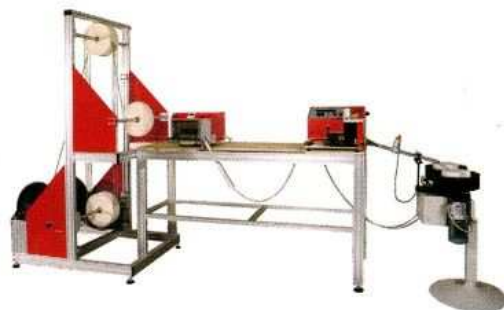
Exemple de ligne de coupe avec dérouleur, tracteur motorisé et bols de lavage
