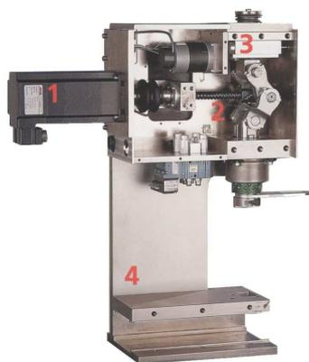
1. Un asservissement à boucle fermée permet une infinité de réglages en terme de vitesse et d'accélération, réduisant ainsi les anomalies d'alimentation de cosses. Un autre servo moteur est par ailleurs utilisé pour régler la hauteur de sertissage avec une précision de 1 $\mu$ .
